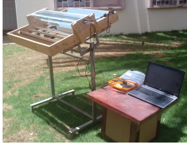
شكل (5) يوضح المجمع الشمسي متصل بأجهزة قياس الضغط ودرجة الحرارة
